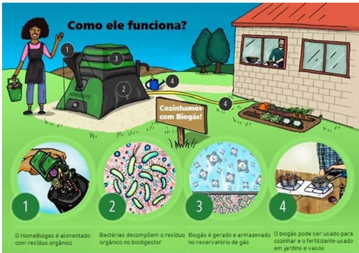
Os sistemas de biodigestão e queima do biogás operam mecanicamente. O biogás sai da câmara de digestão e purificado pelo filtro de carvão ativado antes de ser armazenado no reservatório de biogás em baixa pressão por uma solução patenteada pela HomeBiogas usando sacos de areia instalados acima do reservatório de biogás, que permitem que o gás flua diretamente para o fogão conectado. Acionado, o fogão acende sem demora e fornece uma chama constante para cozinhar.
